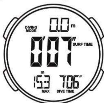
4. Effettuando ripetute immersioni (passaggi 2 e 3), è possibile misurare il tempo e i dati di ciascuna fino ad un massimo di 99 immersioni
